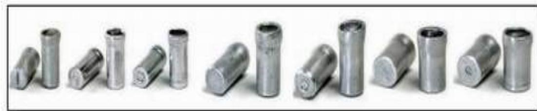
Ein Grundelement der Pressverbindungstechnik ist die im Fließpressverfahren hergestellte Hülse aus Aluminium. Die Hülse ist einseitig geschlossen und am Eingang zur Erleichterung der Drahtführung trichterförmig erweitert. Der Innenraum ist mindestens bis zu 1/3 mit Antioxid – Kontaktpaste gefüllt.
